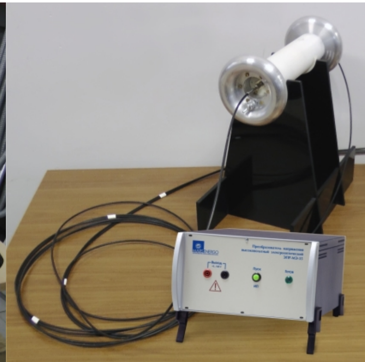
Поверка, калибровка трансформатора напряжения
